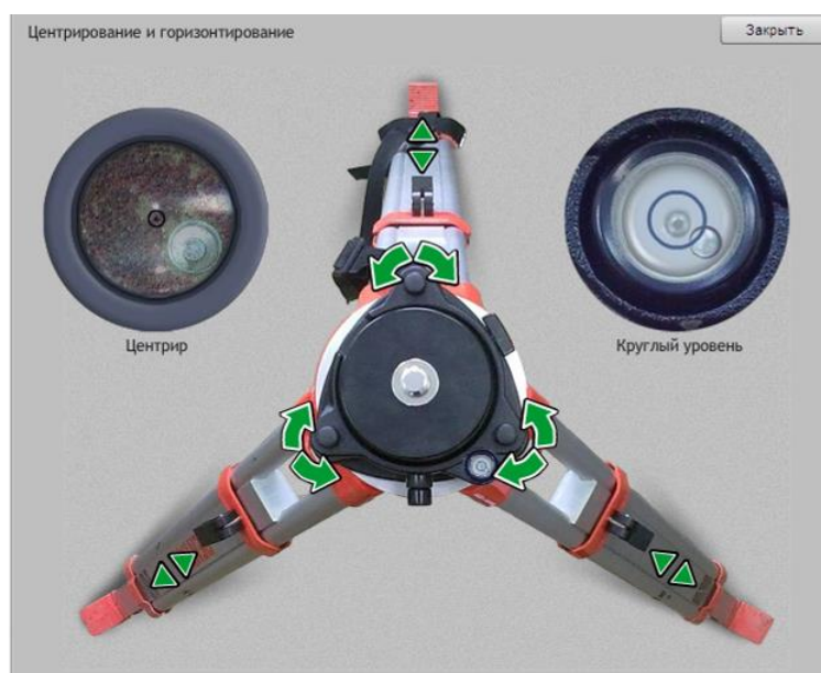
Рис.1. Визуальная модель, виртуализирующая процедуру установки и горизонтирования штатива.
