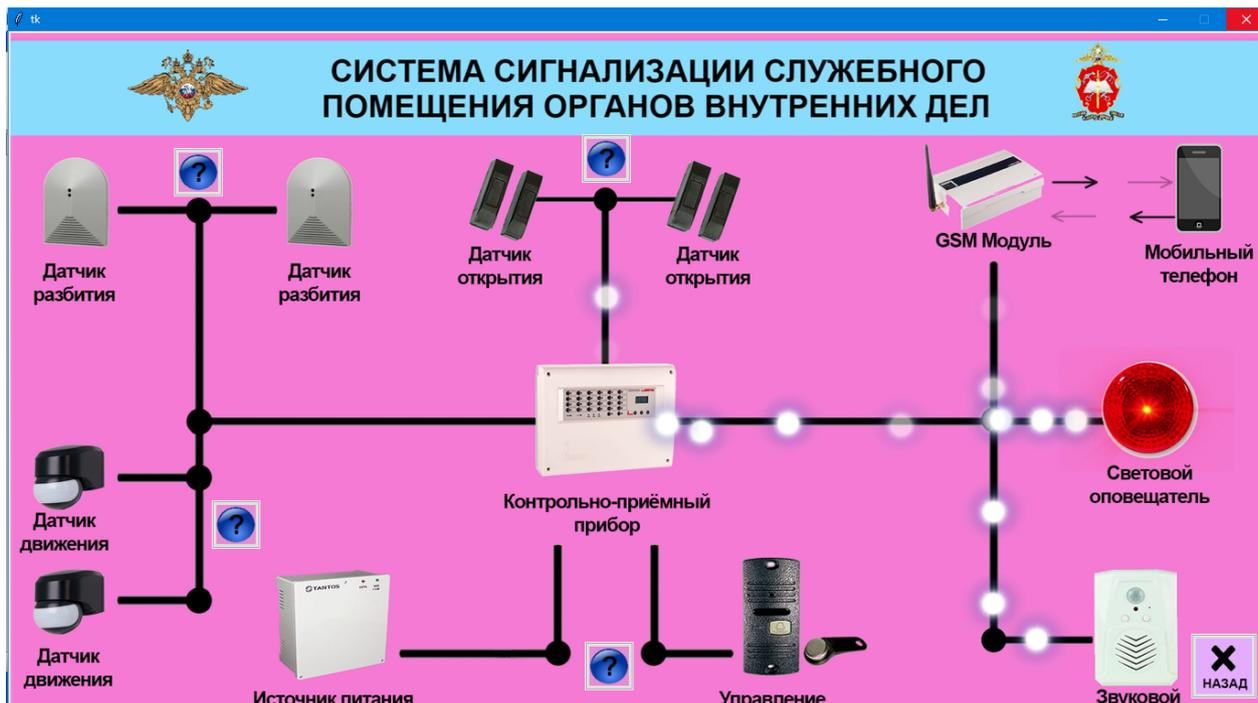
Рисунок 2. Рабочее окно программы, демонстрирующей прохождения сигнала о проникновении на охраняемый объект (помещение)
