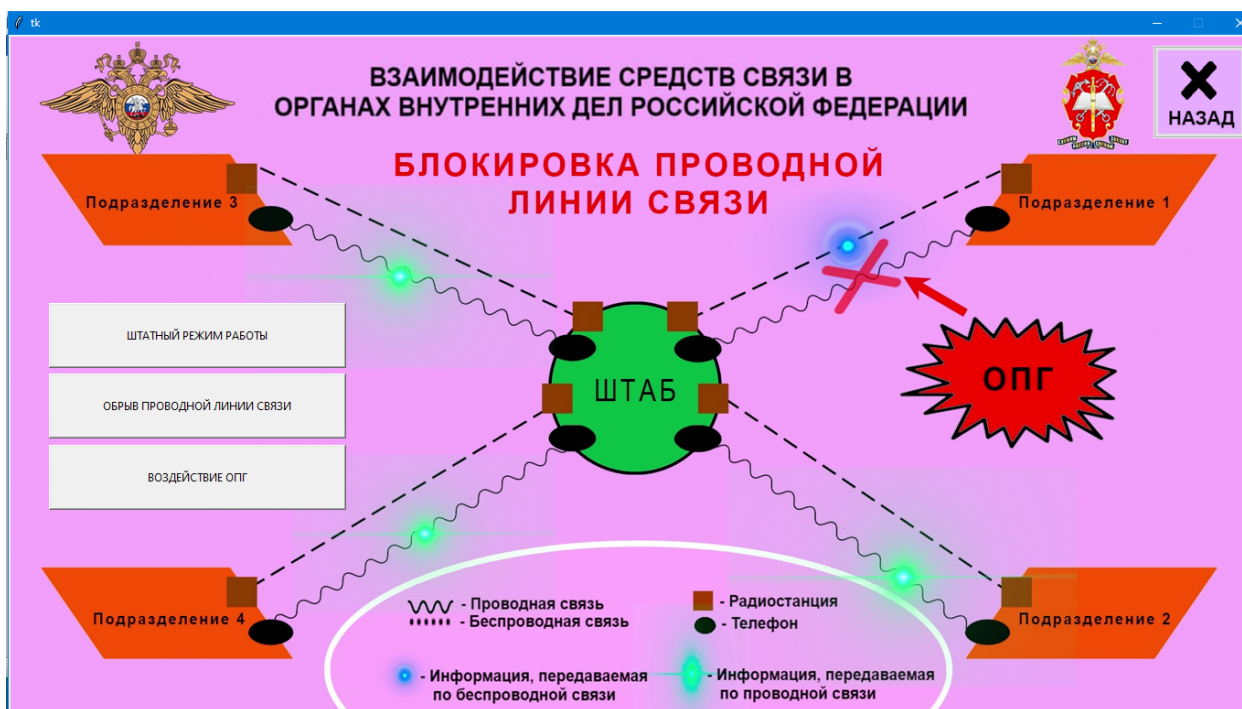
Рисунок 5. Рабочее окно программы демонстрирующей взаимодействия средств радиосвязи в органах внутренних дел Российской Федерации в случае обрыва одной из проводных линий связи и резервирование с помощью радионаправления
